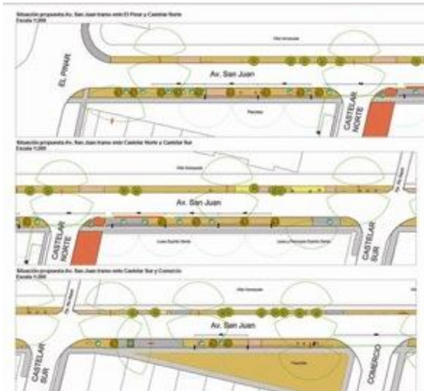
Luminarias peatonales para Av. San Juan vereda poniente
